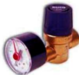
Válvula de seguridad H-H. con toma portamanómetro 1/4" H (manómetro no incluido en precio). Conexión: 1/2". Descarga: 3/4".
